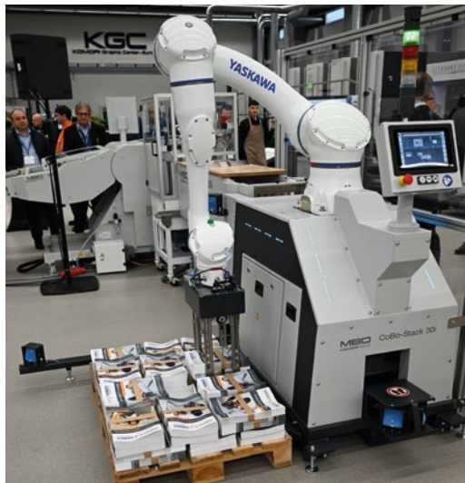
Der MBO CoBo-Stack 30i mit Yaskawa-Roboterarm am Ende der vollautomatischen Digifinisher-Line.
